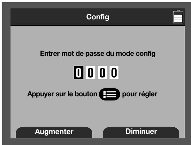
Figure D-1 Accès mode Config
