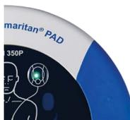
**Figure 11.** Voyant vert clignotant ; aucune action nécessaire.
