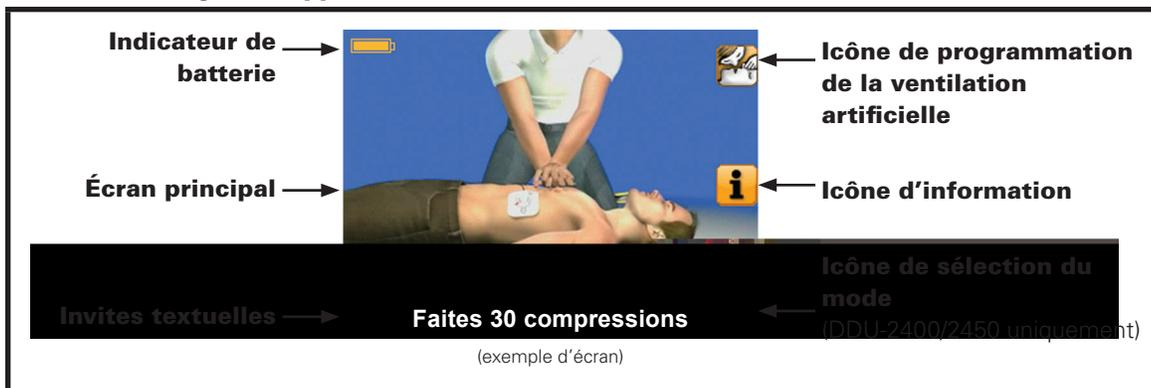
**Indicateur de batterie** – Indique la capacité restante *approximative* de la batterie.
